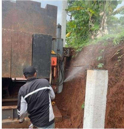
Gambar 4. 7 Kerusakan Kabel *Hidrolis*
