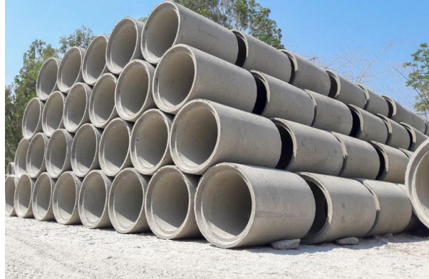
Gambar 2. 4 Buis Beton Tanpa Tulangan
