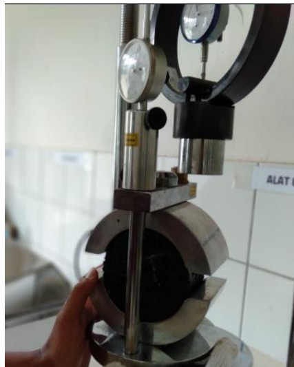
Gambar 4.3 Proses Pengujian Marshall
