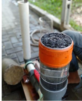
Gambar 4.1 Pengujian Permeabilitas Campuran beraspal berpori
