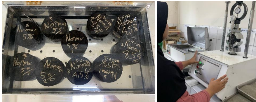
Gambar 3.6 Proses Pengujian Marshall
