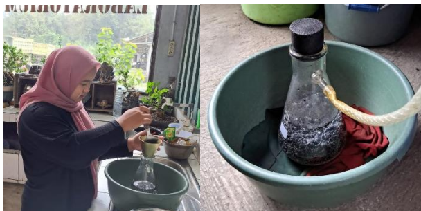
Gambar 3.7 Pengujian Berat Jenis Maksimum
